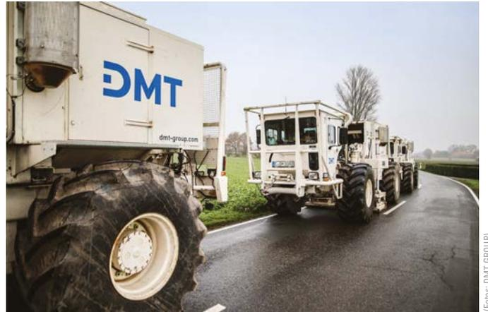
**Bild 2** Mithilfe von seismischen Impulsen können Vibro-Trucks geothermische Potentiale im Untergrund erkunden.
