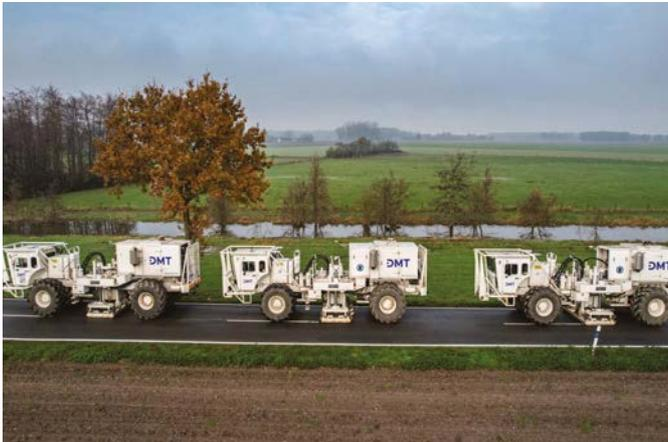
**Bild 1** Durch seismische Impulse können Vibro-Trucks den Untergrund bis in mehrere Kilometer Tiefe erkunden.
