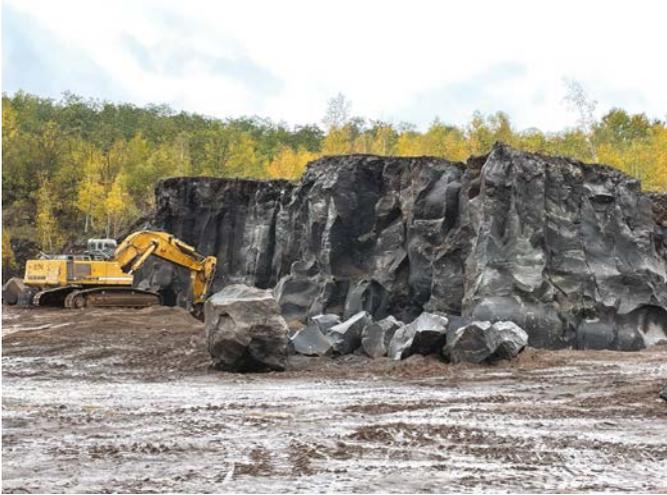
**Bild 1** Der Epiroc HB 7000 beim Einsatz im Basaltsteinbruch
